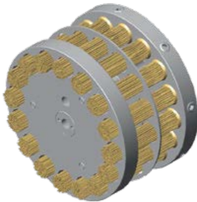
Schematische Darstellung eines Bürstkopfes für Entgratpinsel
