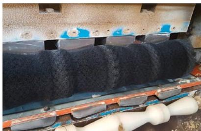
Die vorrätigen Standardkörper können je nach Bedarf umgearbeitet (abgedreht, aufgebohrt) werden, um weitere Abmessungen zu erhalten.
