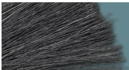
Hohe Dichtwirkung, meistverwendeter Haarbesatz zum Abdichten von Toren, Türen, Drehtüren und Schiebetüren. Diese Besatzart kann im Nass- und Trockenbereich auch bei höheren Temperaturen (bis 150 °C) eingesetzt werden. Ihre statische Aufladung ist gering. Standardmäßig verwenden wir eine Mischung aus 70 % Rosshaar und 30 % Polyethylen.
