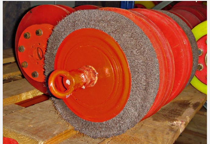
Ein Reinigungsmolch mit mehreren verbauten Walzenbürsten
