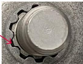
Durch die geringere Einspannhöhe greift nun zuverlässig die Arretierung der Druckscheibe an der Aufnahme der Sense.
