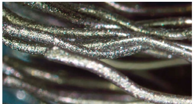
Das Bild zeigt Diamantbesatz. Diamantbesatz eignet sich besonders für aggressive Anwendungen und bei Materialien mit hoher Werkstofffestigkeit.
