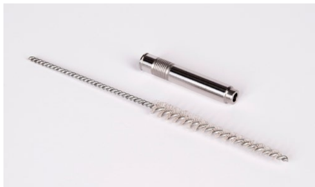
Werkstück mit passend stufig geschnittener Innenbürste
