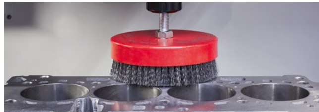
Entgraten eines Motorblocks mit einer Tellerbürste (Drahtbesatz)
