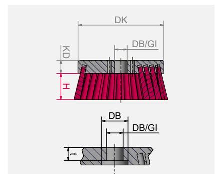
Die vorrätigen Standardkörper können je nach Bedarf umgearbeitet (abgedreht, aufgebohrt) werden um weitere Abmessungen zu erhalten.
