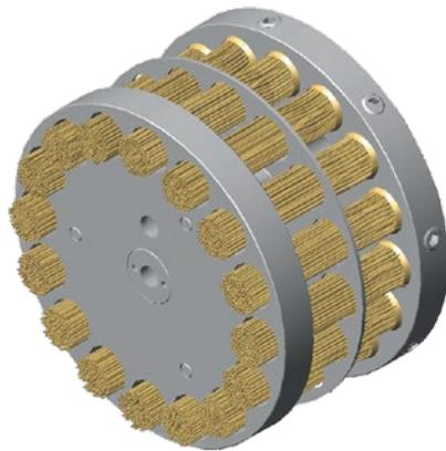
Schematische Darstellung eines Bürstkopfes für Entgratpinsel
