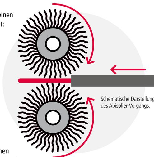
Schematische Darstellung des Abisolier-Vorgangs.
